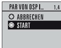
Im Messmodus drücken Sie ► um in den Programmiermodus zu gelangen. Wählen Sie Quick Start (1.), dann PAR VON DISP KOP (1.4.) Drücken Sie ►, wählen dann START und drücken ►. PARAM DOWNLOAD wird angezeigt. Danach geht das Gerät in den Messmodus zurück.
