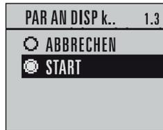
Im Messmodus drücken Sie ► um in den Programmiermodus zu gelangen. Wählen Sie Quick Start (1.), dann PAR AN DISP KOP (1.3.) Drücken Sie ►, wählen dann START und drücken ►. PARAM UPLOAD wird angezeigt. Danach geht das Gerät in den Messmodus zurück.
