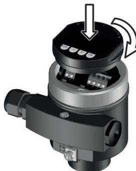
Рис. 19: Установка модуля индикации и настройки в отсеке электроники однокамерного корпуса
