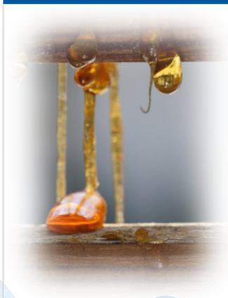
El cemento o la harina son ejemplos clásicos de cómo a veces pueden producirse acumulaciones en las piezas que entran en contacto con el proceso en aplicaciones sólidas. En los sensores TDR, una de esas piezas en contacto con el proceso es la sonda. Se utiliza una varilla o un cable. Las superficies respectivas están diseñadas para **minimizar la acumulación de producto**. Además, las respectivas variantes de cuerda pueden recubrirse con un **Revestimiento PA**.
