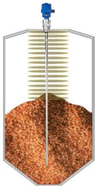
*Dado que los impulsos de microondas se guían a lo largo de una sonda, los conos de tiro no influyen en su comportamiento de reflexión. Así se evita la pérdida de señal debida a las microondas reflejadas hacia los lados.*
