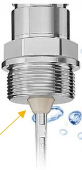
*Un cono de condensado que tiene un efecto aislante entre el acoplamiento y la sonda aumenta la fiabilidad de la medición y también facilita el goteo del condensado.*
