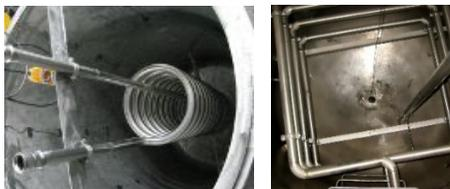
*Eje calefactor en el interior de un depósito: Ningún problema para los sensores TDR con sonda coaxial. Las bobinas de calentamiento tampoco son fuente de interferencias con las sondas coaxiales.*
