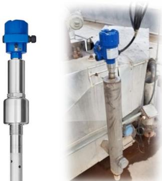
*Os sensores TDR com sondas coaxiais são a forma mais confiável de determinação de nível. Um tipo de instalação popular para sensores TDR é o bypass. O efeito do tubo de desvio é comparável ao de um tubo coaxial..*
