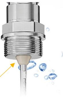
*Um cone de condensado com efeito isolante entre o acoplamento e a sonda aumenta a confiabilidade da medição e também facilita o gotejamento do condensado..*
